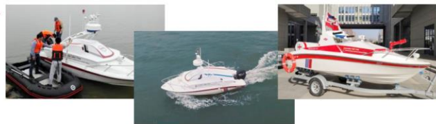
“精湖壹号”水质水文监测无人船具有高度智能，可自主航行、自动避障、自动回收等，可完成总氮、总磷、氨氮、COD等11项水质指标的在线监测，同时基于声学多普勒探测模块，实现水文数字流场图的在线自动生成。
